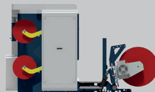
C+ Passaggio del materiale sotto pedana: carro di svolgimento semi integrato
