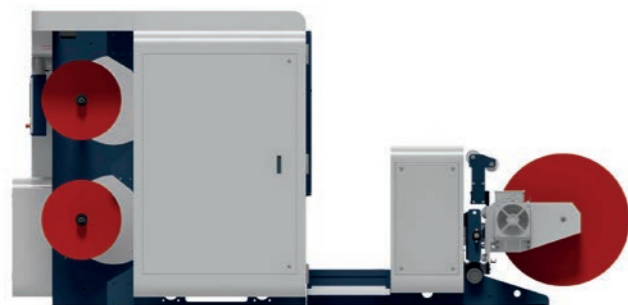
B Passaggio del materiale sotto pedana: carro di svolgimento indipendente
