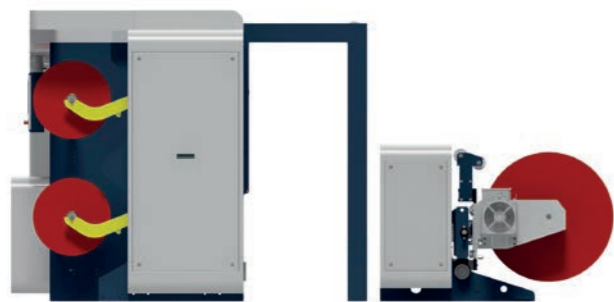
D Passaggio aereo del materiale: avvolgimento sul lato opposto dello svolgimento
